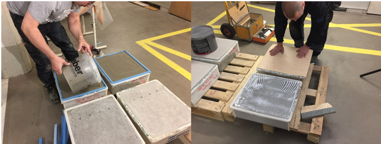
Fig. 2 Framtagning av mätobjekt. Vänster – avjämning av två av plattorna, höger – pålimning av ytskikt direkt på betongytan.
